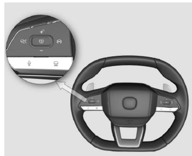
Кнопки управления системой АСС на рулевом колесе
